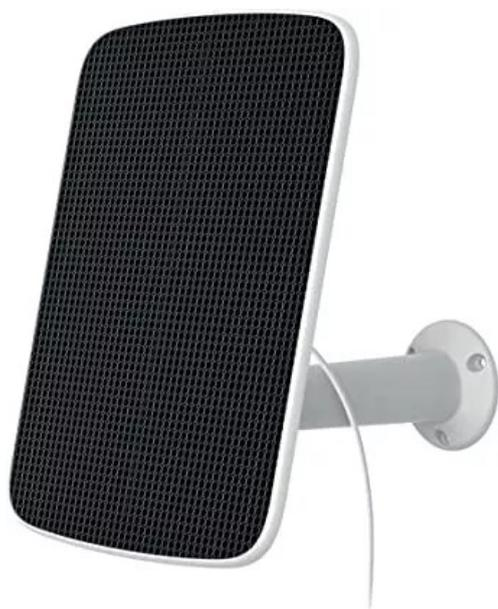
Composé de cellules solaires en silicium monocristallin, le panneau solaire fournit jusqu'à 6,18W de puissance. Support réglable pivotant à 360 degrés avec câble de 4 mètres de long.
