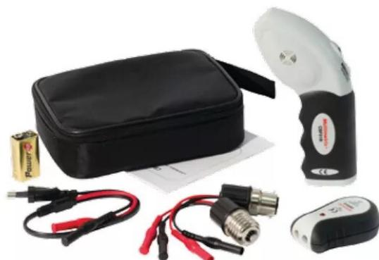
Livré en sacoche de transport avec 1 émetteur - 1 récepteur - 3 adaptateurs : 3 A B22 baïonnette, douille E27 (vis) - 1 pile 9 V - 1 notice
