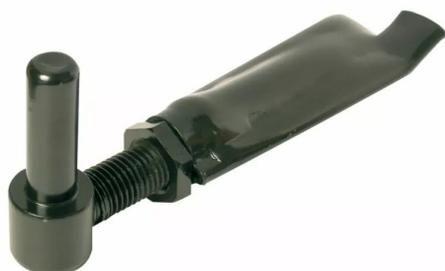
Grâce à sa forme et son écrou, le réglage du gond à sceller est fin et précis. Quelques tours de clé permettent de régler, sans dépose, les jeux du portail et de compenser les dilatations hiver/été.
