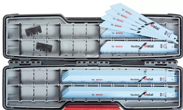
S922EF : lame standard bimétal. Denture à pas très fin pour découpe de tuyaux/profilés (1,5-4 mm) jusqu'à 100 mm.
