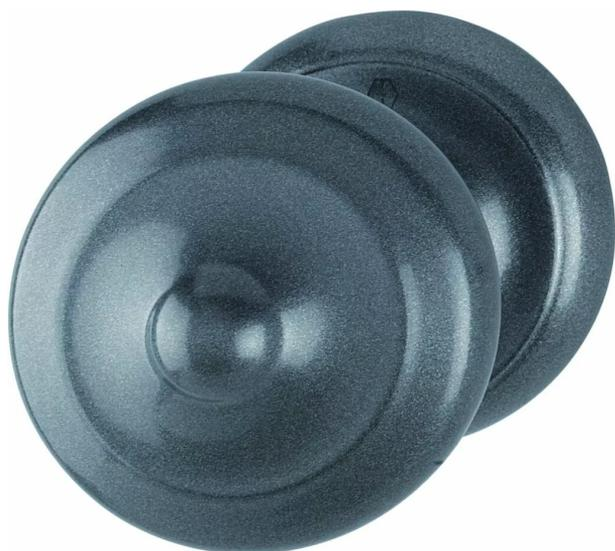
Bouton de porte fixe sur rosace, en aluminium finition fer forgé. Fixation par carré à montage rapide.  $\varnothing$  bouton 80 mm.  $\varnothing$  rosace 75 mm.
