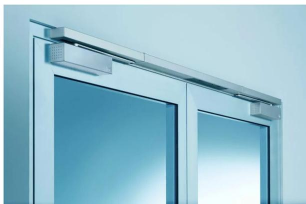
Un sélecteur de fermeture à bandeau Dorma comprend une glissière pour vantail de service, une glissière pour vantail semi-fixe et un jeu de caches avec bras de ferme-porte et tube de liaison. Pour porte largeur mini. 1350 mm et maxi. 2500 mm, 3200 mm maxi. sur demande. Il permet aussi d'équiper des portes à 2 vantaux asymétriques ou non, avec une largeur minimale du vantail semi-fixe de 370 mm. Conformité accessibilité : résistance à l'ouverture inférieure à 50 N d'effort.
