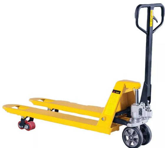
Une conception robuste avec pompe monocorps et timon ergonomique en caoutchouc moulé antidérapant. Roues jantes alu et bandage caoutchouc. Boogies en polyuréthane montés sur roulement à billes. Longueur des fourches : 1150 mm. Largeur des fourches : 540 mm. Dimensions totales : L 1150 x H 1240 mm.
