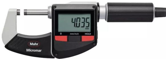
Micromètre avec étrier numérique, en acier laqué, à isolation thermique.
