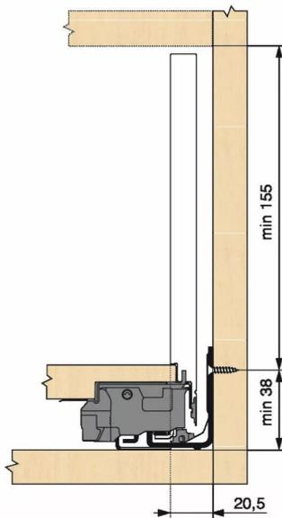
Tiroir à bords droits et fins épaisseur 12,8 mm montés sur coulisses invisibles extra-plates. Coulissement extra-léger. Amortissement BLUMOTION à la fermeture. Versions TIP-ON et TIP-ON BLUMOTION pour solutions sans poignées.
