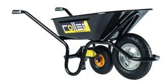
Châssis Alpha tube peint ø 32 mm, ergonomique et indéformable, avec support soudé. Caisse peinte 100 litres. La charge transportée est répartie entre la roue principale et la roulette cette dernière est enclenchée par un ressort, dès qu'on soulève la brouette. Déverrouillable par pédale. Lorsque la roulette est au sol, l'utilisateur n'a plus besoin de soulever la charge. Charge utile 250 kg.
