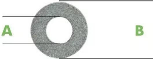
A =  $\varnothing$  intérieur / B =  $\varnothing$  extérieur / E = épaisseur.
