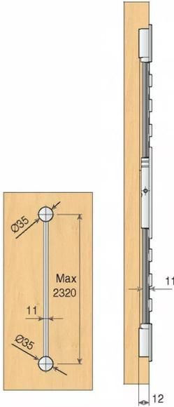
Kit comprenant 1 + 1 barres filetées (gauche) - 1 barillet en nylon - 6 platines de support en nylon - 2 profils en aluminium - 1 platine centrale de support en nylon
