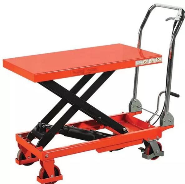
Levage par pompe à pied hydraulique. Descente du plateau par manette située en haut du timon. 4 roues  $\varnothing$  125 dont 2 roues pivotantes avec frein pour une bonne stabilisation de la table pendant la charge et la décharge. Hauteur timon 980 mm. Charge maxi. 300 kg.
