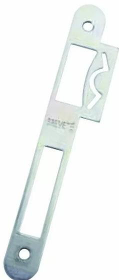
Fonctionnement du système de réglage : dans le cas où la porte installée a trop de jeu : positionner un tournevis plat dans la fente, puis en le faisant pivoter vous allez écarter les bords de la fente et ainsi réduire la largeur du logement de gâche.
