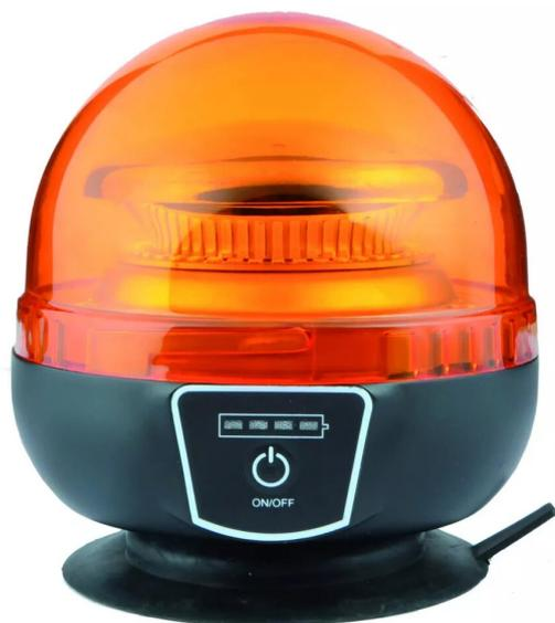
Gyrophare couleur ambre 36 W. 3 modes d'éclairage flash, double flash, rotatif. Embase caoutchouc magnétique avec ventouse et joint d'étanchéité anti-vibration. Fonctionne sur batterie lithium avec témoin de charge. Ampoules 12 leds. Autonomie mode Flash 3 h. Tension 12-24 V DC. Dimensions : ø 125 x H 150 mm. Homologué ECE R65/R10, EMC. IP 56.
