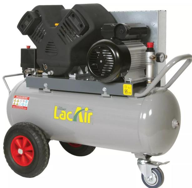
Entraînement par courroie. Groupe fonte bicylindre en V caréné à triple segmentation. Culasse en aluminium. Cuve 50 litres. 3 sorties raccords rapides : 1 directe et 2 filtrées/régulées sur épurateur détendeur PM. Double brancard. Contacteur manométrique. Tuyauterie cuivre grosse section. Clapet anti-retour, soupape de sécurité et robinet de purge.
