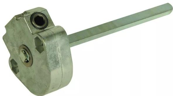
Treuil avec fin de course avec un carter en zamak réduction 1/6 entrée du treuil 6 pan de 7 mm sortie carré de 8 mm mâle. Il est livré avec tige carré de 8 mm, longueur 125 mm démontable. Diamètre du treuil 65 mm, entraxe de fixation 48 mm, épaisseur 21 mm.
