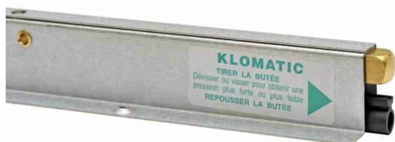
Plinthe automatique encastrable, réversible, pour bas de porte. Assure une étanchéité parfaite. Absolument invisible. Fonctionnement type guillotine, côté paumelle. Tôle alu zinc anticorrosion. Longueur pouvant être recoupée de 9,5 cm maxi. Réglage de la course de fermeture au quart de tour grâce à sa butée carrée en laiton. Calfeutre un jour jusqu'à 13 mm. Équipé d'un joint néoprène souple. Embase de 34 mm, hauteur de mortaise de 27 mm, largeur 12 mm.
