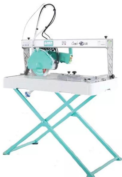
Légère et compacte, la Combi 250VA convient pour la découpe verticale ou inclinée jusqu'à 45° de céramique, la pierre, les briques et les tuiles. Plan de coupe en acier inoxydable. Bac de récupération d'eau en plastique antichoc. Transmission directe. Pompe à eau électrique (13 l/mn). Butée millimétrée. Interrupteur IP55 avec bobine de tension minimale. Prise IP67.
