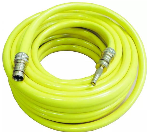
Tuyau 5 couches en qualité standard. Tube intérieur lisse en PVC, couche intermédiaire en PVC 100% recyclé. Armature en fibre polyester haute ténacité. Revêtement en PVC souple anti-UV. 20 bars de pression test.
