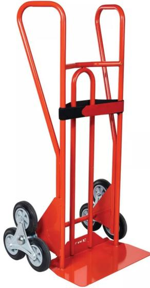
Diable à bayette fixe et tablier incurvé pour un bon maintien en place des charges durant le transport. Structure mécano-soudée en tube  $\varnothing$  25 mm. Deux roues triples en caoutchouc non tachant  $\varnothing$  160 mm. Moyeu serti et soudé. Dimensions : L 533 x l 612 x H 1216 mm. Dimensions bassettes : 490 x 180 mm. Charge utile : 250 kg. Poids : 17 kg. Livré monté avec une sangle scratch. Garantie 10 ans.
