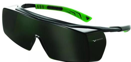
Surlunettes teinte 5 pour le soudobrasage, la soudure au gaz ou au plasma. Protection contre les projections mécaniques, les UV, les infrarouges et la lumière vive. Qualité optique classe 1 pour port permanent, résistance à l'impact (45m/s) à des températures extrêmes (-5°C / +55°C). Revêtement anti-rayures multi-couches sur les 2 faces. Branches droites ajustables en longueur. Surlunettes compatibles avec des verres progressifs. Normes : EN 166, EN 167, EN 168, EN 169, EN 175.
