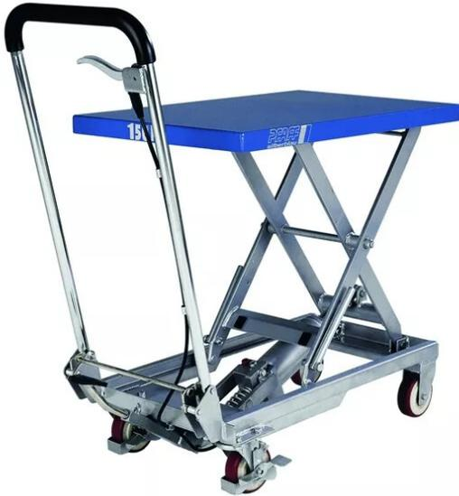
Structure robuste avec tiges de piston chromées et limiteur de charge. Levage par une pompe à pied hydraulique. Vitesse d'abaissement modulable grâce à une vanne hydraulique ajustable. 4 roues  $\varnothing$  128 mm dont 2 avec frein de parking pour assurer la stabilisation de la table en charge.
