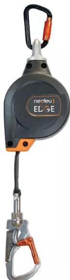
Léger et compact, cet antichute est équipé d'une longue sangle automatique rétractable de 6 m, avec système à double cliquet : permet d'amortir la chute en dissipant l'énergie. Poids : 1,8 kg.
