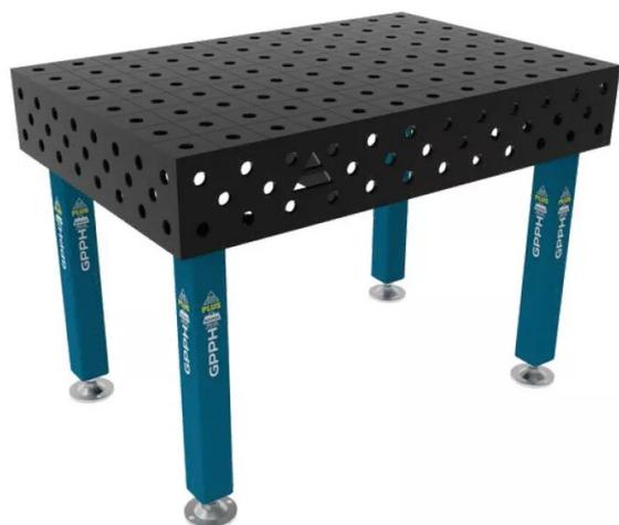
Cadre rigide en métal. Plateau de travail 1200 x 800 mm en acier S355J2+N avec grille de perçage 100 x 100 mm (perforations  $\varnothing$  16 mm). Paroi latérale largeur 200 mm et bords de table fraisés. 4 pieds section 80 x 80 mm réglables en hauteur individuellement. Capacité de charge statique 2 tonnes. Poids : 220 kg.
