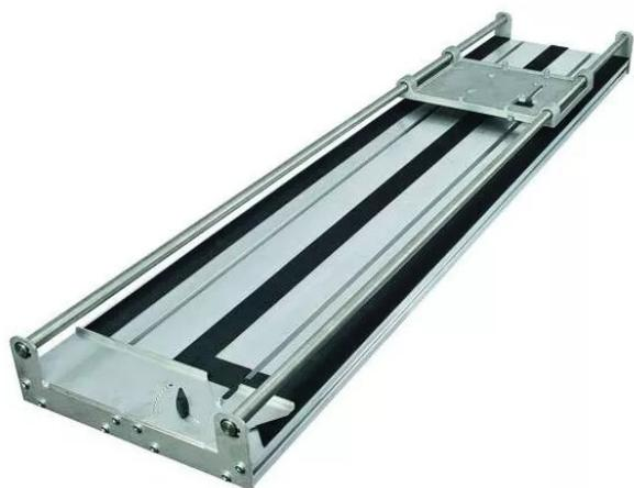
Couplée aux tables de coupe, elle devient l'alternative idéale aux scies sur table lourdes et encombrantes. Facile et maniable grâce au guide de coupe avec roulements, évite les traces ou rayures sur le matériau. Réglage de l'inclinaison (jusqu'à 45°) et de la profondeur de coupe (jusqu'à 36 mm). Alésage du disque : 22,23 mm. Raccordements directs : à l'aspirateur pour une meilleure évacuation des poussières, et à l'arrivée d'eau avec un réglage du débit. Dimensions : L 460 x l 360 x H 380 mm.
