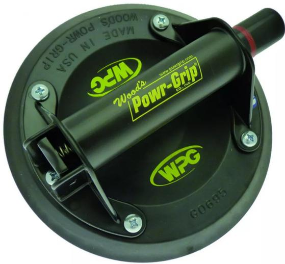
La pompe à vide, située dans la poignée, est actionnée par pressions successives sur le piston. Un clapet casse-vide permet de libérer la ventouse.
