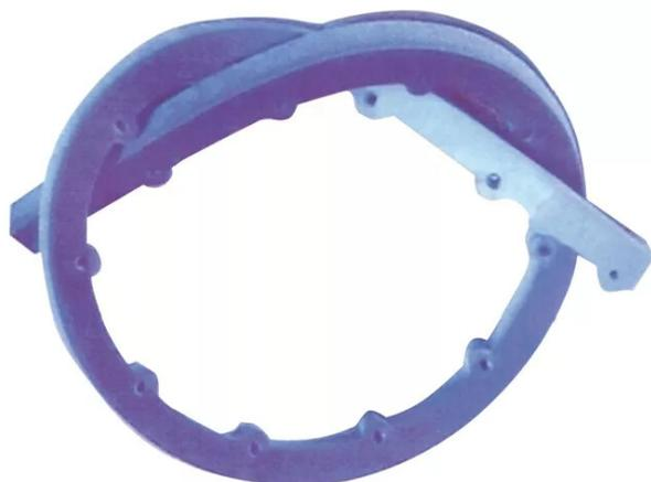
Le Courbeslifix facilite la réalisation de vos chapeaux de gendarme, mais aussi de toutes autres formes courbées. Sa mise en oeuvre est rapide et aisée. Tracez votre courbe, dégrossissez à la scie et vissez le Courbeslifix le long du tracé. Passez ensuite le futur gabarit au calibre ou à la fraise à copier de votre défonceuse en veillant à appuyer le roulement à billes contre le Courbeslifix. Dévissez la règle et votre gabarit est terminé !
