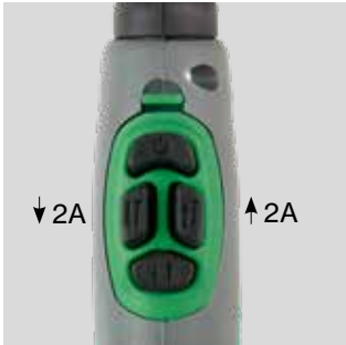
Module 4 touches pour le réglage du courant de soudage y compris fonction TIG-A-Tack. Augmentation/diminution du courant de soudage de 2 ampères. Appui long pour augmentation/diminution en continu. Réf. n°.....80300063* * S'applique aux versions logicielles à partir de 2.17
