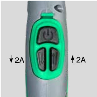
Module 3 touches pour le réglage du courant de soudage. Augmentation/diminution du courant de soudage de 2 ampères. Appui long pour augmentation/diminution en continu. Réf. n°.....80300064* * S'applique aux versions logicielles à partir de 2.17
