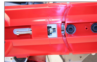
Tendeur de courroie facilement accessible
