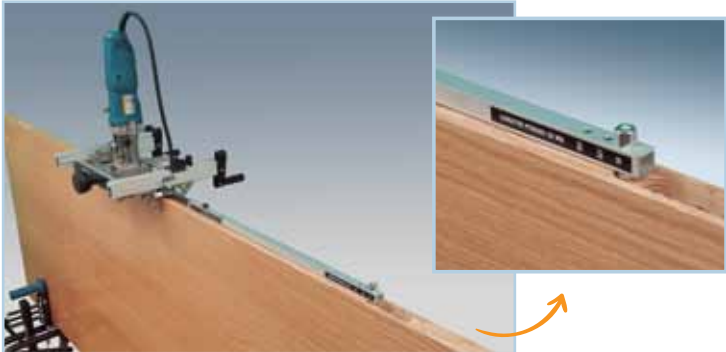
Entaillage sur l'ouvrant, 2 ème paumelle. Règle de division avec doigt palpeur, écartement réglé pour 3 ou 4 entaillages symétriques.
