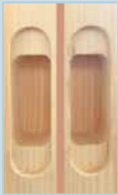
Usinage de paumelle invisible
