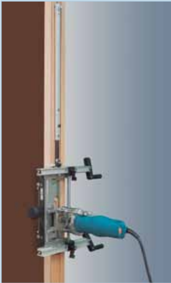
Entaillage du dormant, 2 ème paumelle.
