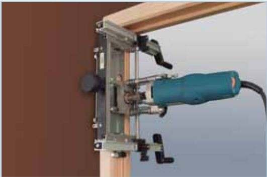
Entaillage sur la partie supérieure du dormant, 1 ère paumelle.
